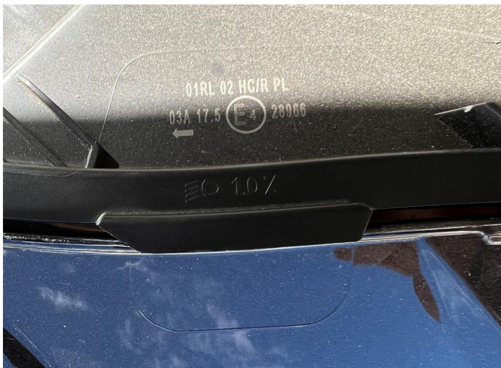
Slika 14. Nagib svjetala koju je odredio proizvođač
