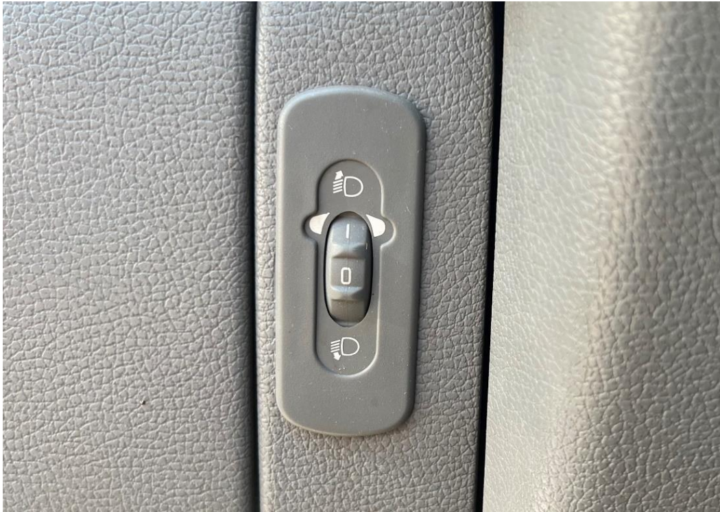
Slika 15. Uređaj za podešavanje visine svjetala u vozilu
