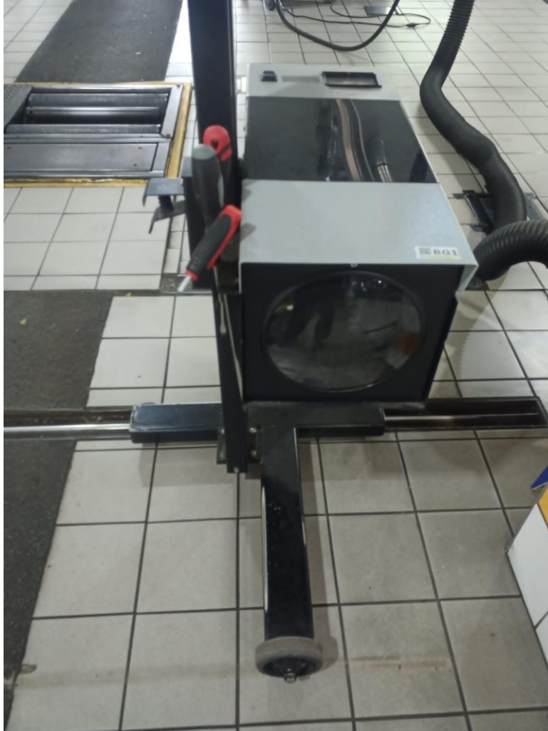
Slika 6. Regloskop na vodilicama
