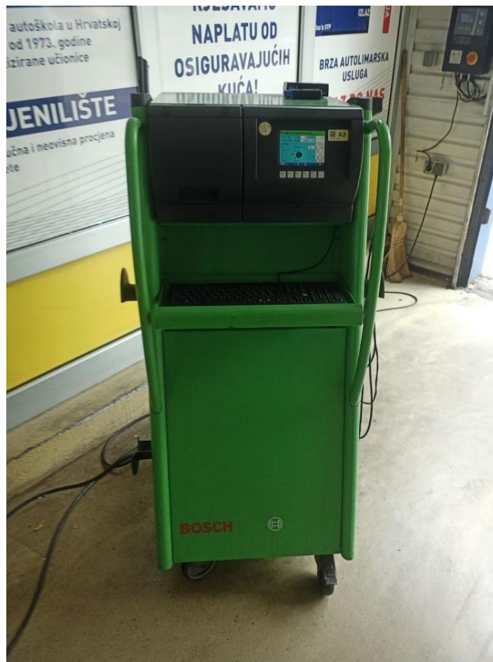
Slika 8. Uređaj za mjerenje zamućenosti ispušnih plinova
