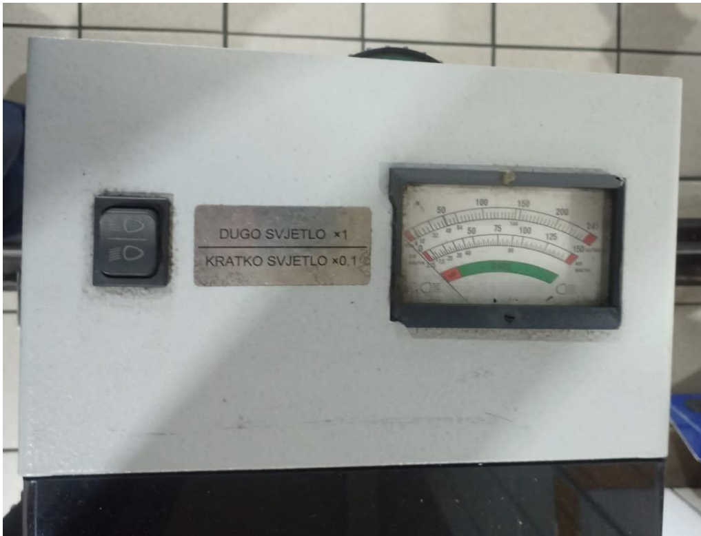
Slika 7. Dio regloskopa za mjerenje jačine svjetlosnog snopa
