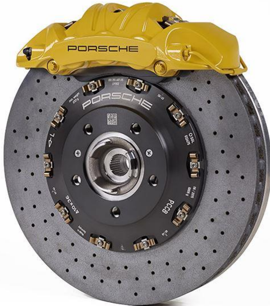
Slika 1. Karbon keramičke kočnice
