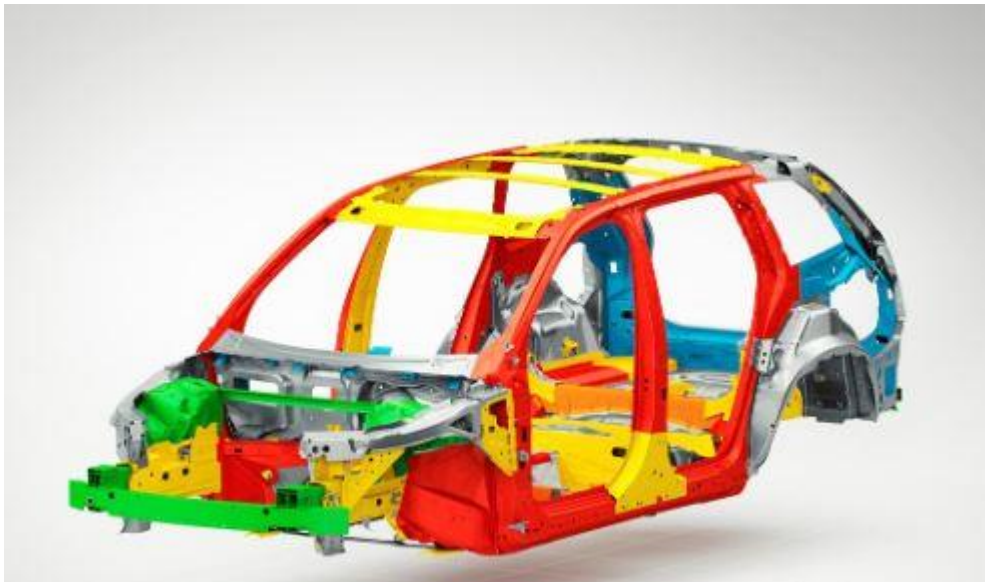
Slika 3. Prikaz različitih materijala karoserije Volvo automobila
