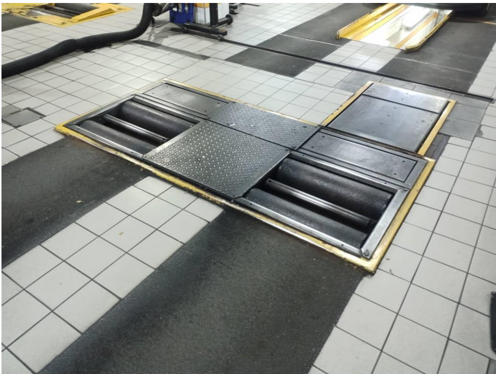
Slika 5. Uređaj s valjcima s kojim se provjerava sila kočenja
