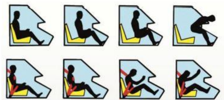
Slika 4. Simulacija kretanja tijela pri frontalnom sudaru
