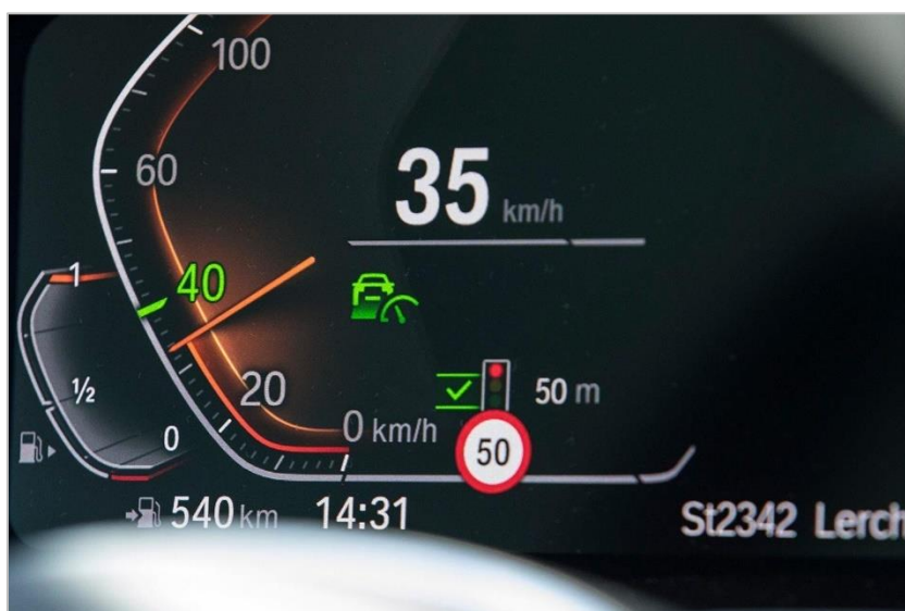
Slika 18. Prikaz TSR-a s prilagodljivim tempomatom, [27]
