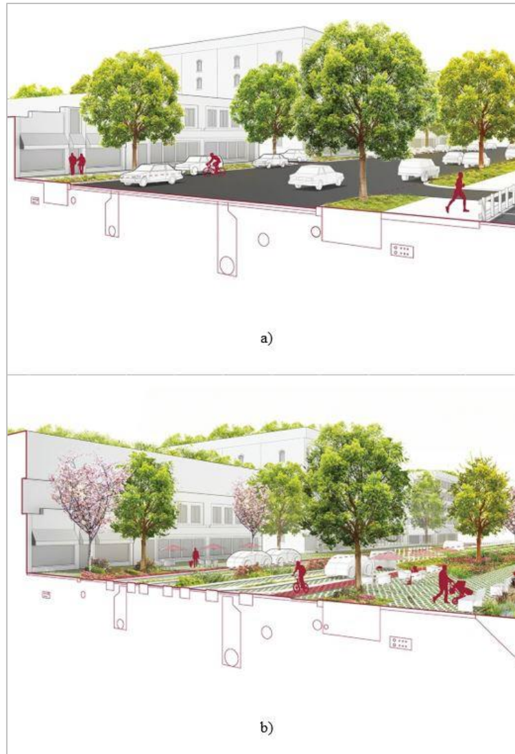
Slika 31. Poprečni profil klasične ceste (a) i ceste za AV-ove (b)
