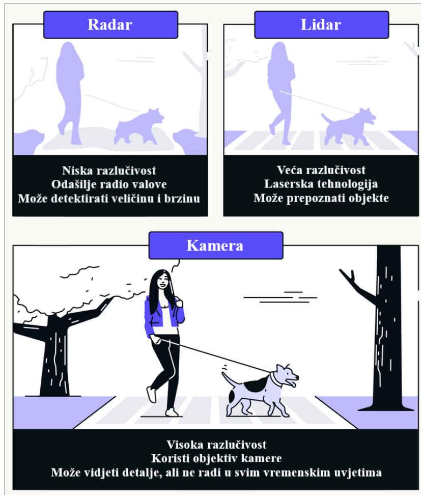
Slika 16. Razlika između načina percepcije radara, lidara i kamere na automatiziranom vozilu
