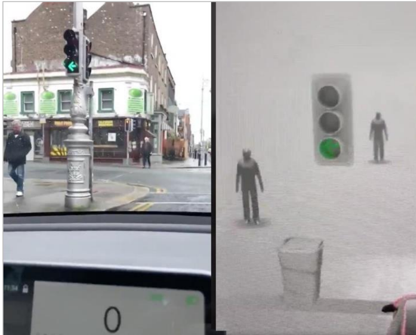
Slika 19. Prepoznavanje semafora i pješaka - Tesla Autopilot, [27]
