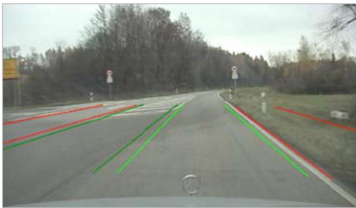
Slika 22. Nepravilno praćenje prometnih traka unutar raskrižja, [29]
