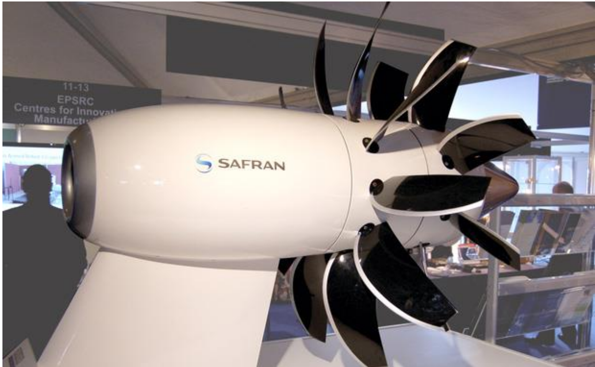
Slika 14. Motor s otvorenim rotorom
