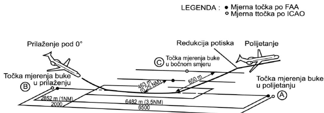
Slika 2. Točke mjerena razine buke na zračnim lukama
