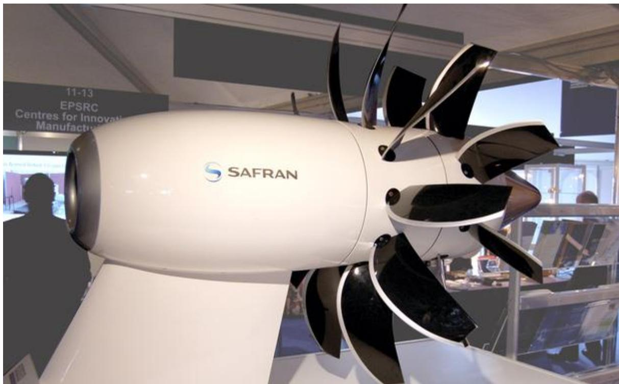
**Slika 14.** Motor s otvorenim rotorom
