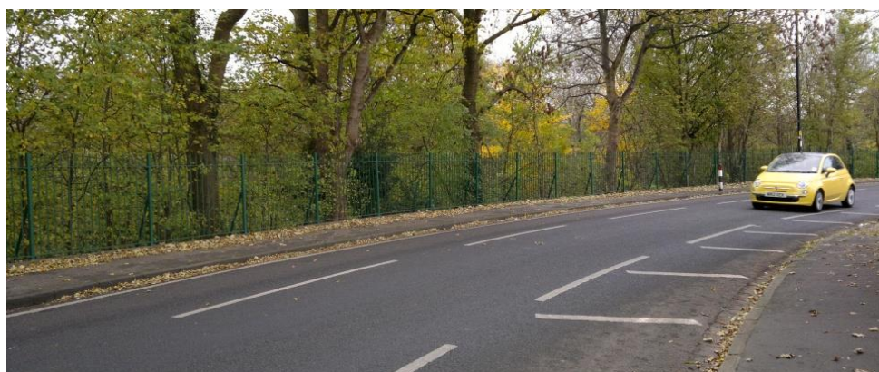
Slika 14. Kose oznake na kolniku u zavoju u Ujedinjenom Kraljevstvu Izvor: [61]
