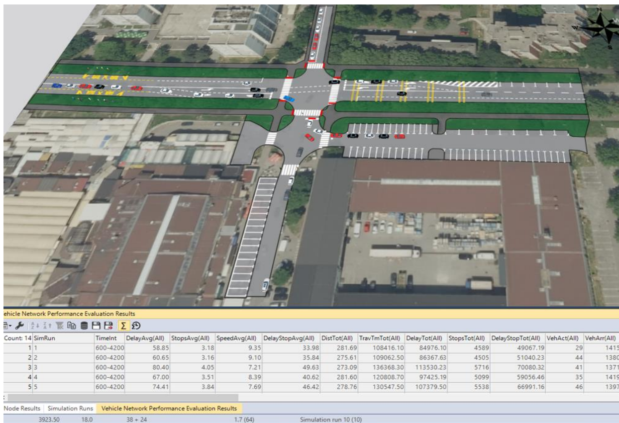
Slika 40. Prikaz simulacijskog modela postojećeg stanja u programskom alatu PTV Vissim
