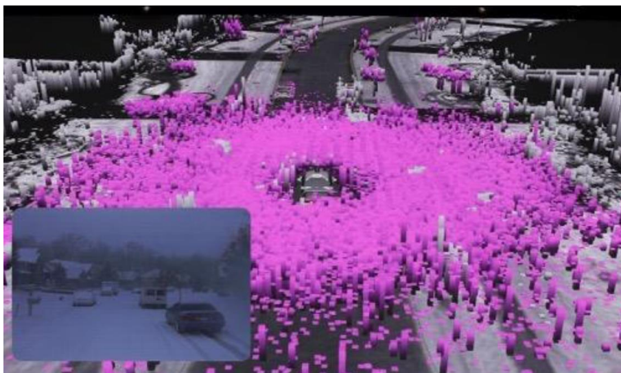
Slika 4: Smetnje za lidar izazvane snijegom
