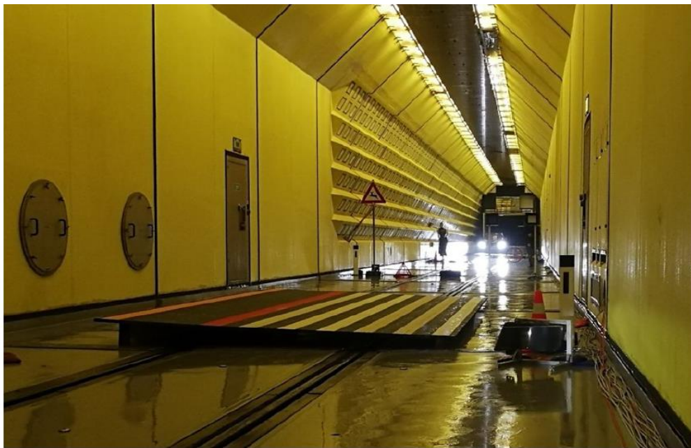
Slika 19: Klimatski zračni tunel s testiranim oznakama
