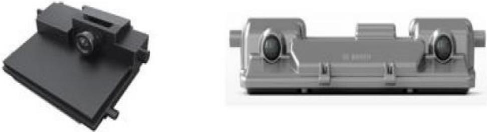
Slika 16: Monokularna i stereo kamera
