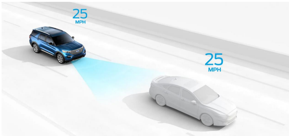
Slika 7: Prikaz ACC sustava
