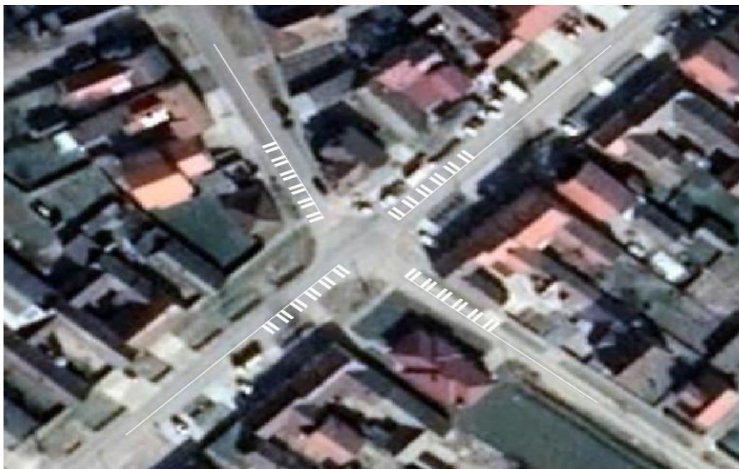
Slika 31: Prijedlog rješenja za smirivanje prometa u Selcu Đakovački
