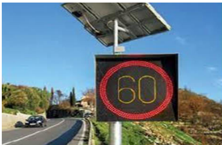
Slika 32: Prikaz solarnog promjenjivog znaka
