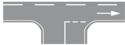
Slika 3. Poprečna isprekidana crta zaustavljanja (H15)
