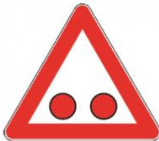
Slika 35. Prometno svjetlo za označavanje prijelaza ceste preko željezničke pruge (G13)
