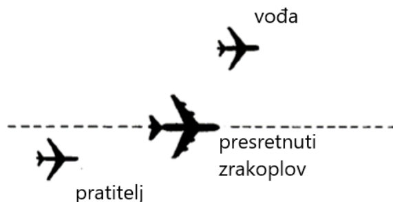
Slika 2. Pozicioniranje zrakoplova presretača u odnosu na presretnuti zrakoplov u svrhu pružanja navigacijske pomoći
