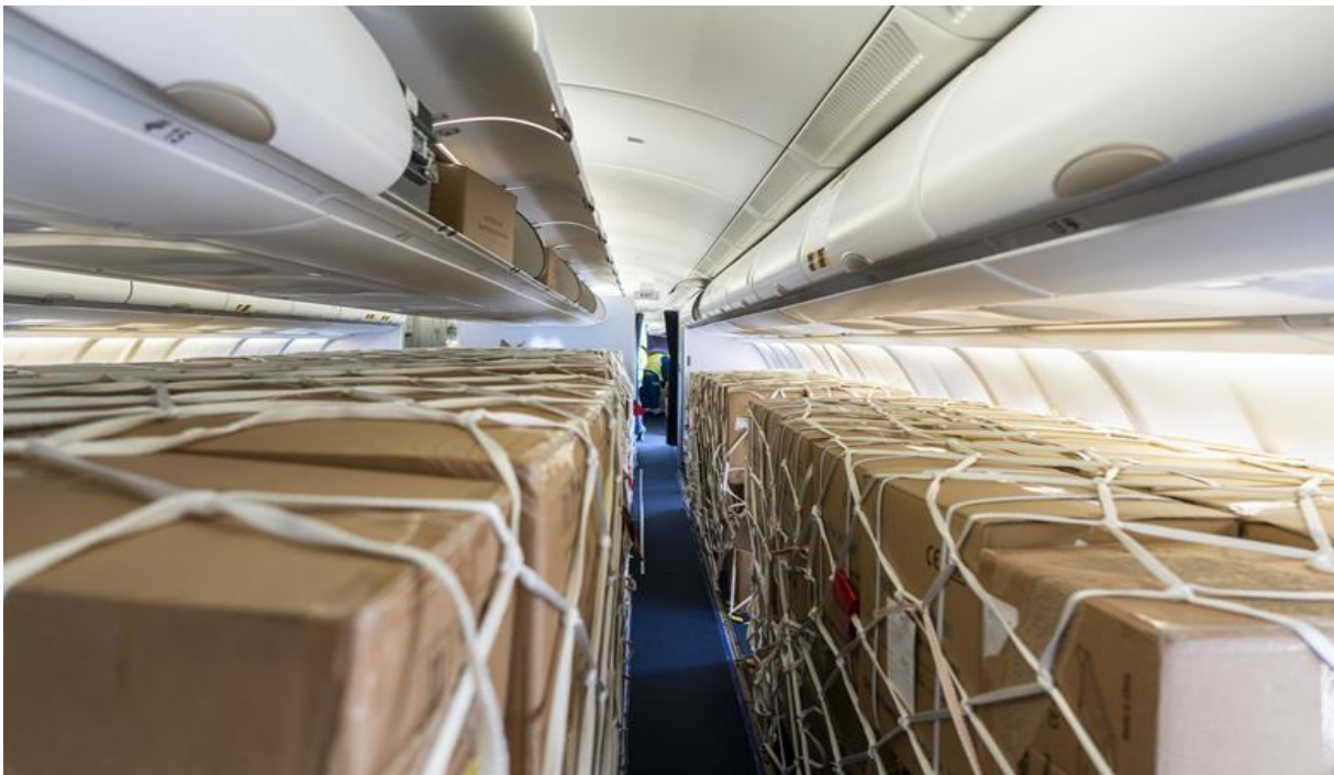
Slika 5. Prijevoz tereta A320 u putničkoj kabini nakon uklanjanja sjedala, [16]
