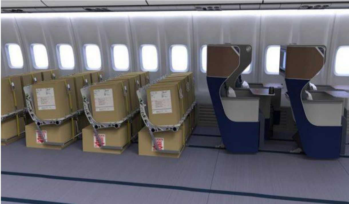
Slika 6. Prijevoz tereta u putničkoj kabini A330 nakon uklanjanja sjedala iz ekonomske klase, [16]
