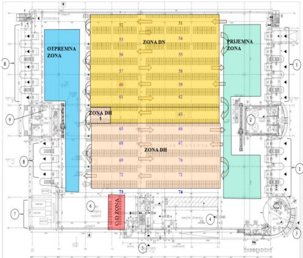
Slika 24: Prikaz tlocrta prizemlja distributivnog centra "Tvrčke"
