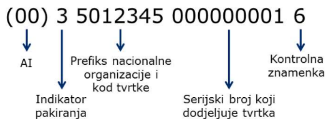
Slika 32: Dijelovi SSCC barkoda
