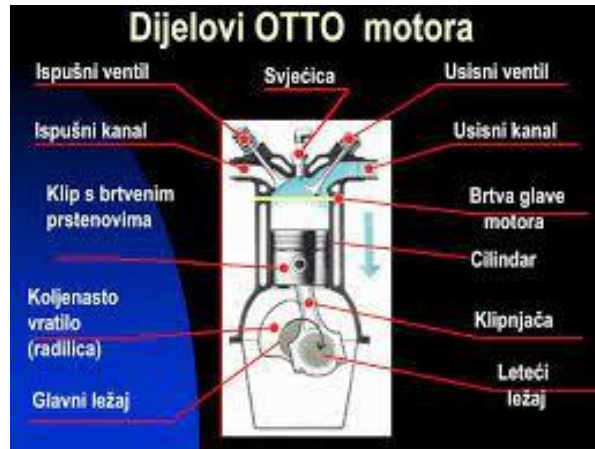
Slika 3. dijelovi Otto motora [9]
