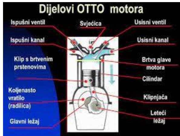
Slika 3. dijelovi Otto motora [9]
