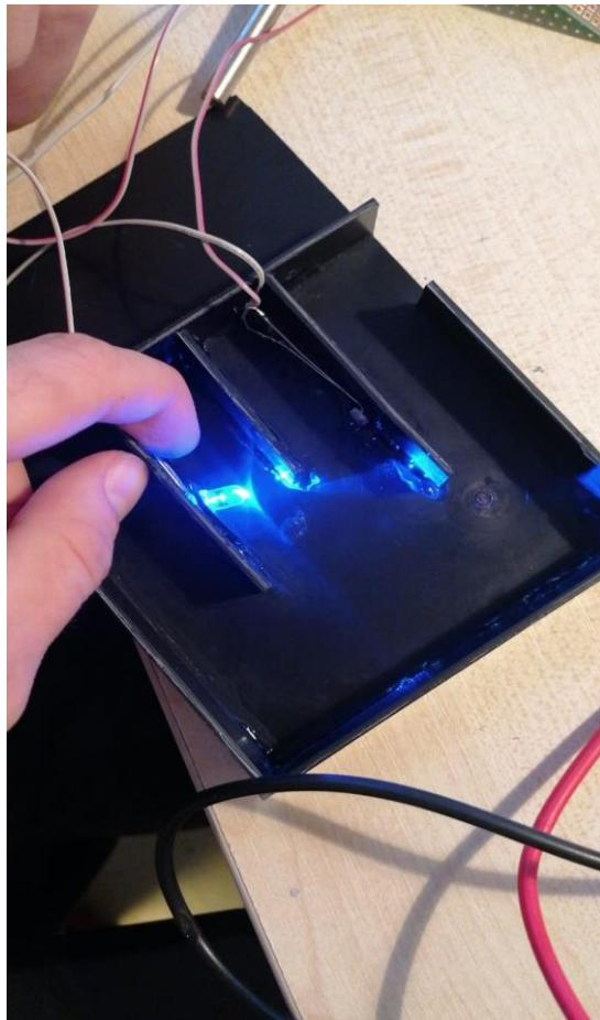
Slika 14. Način instalacije svjetleće diode i foto-otpornika
