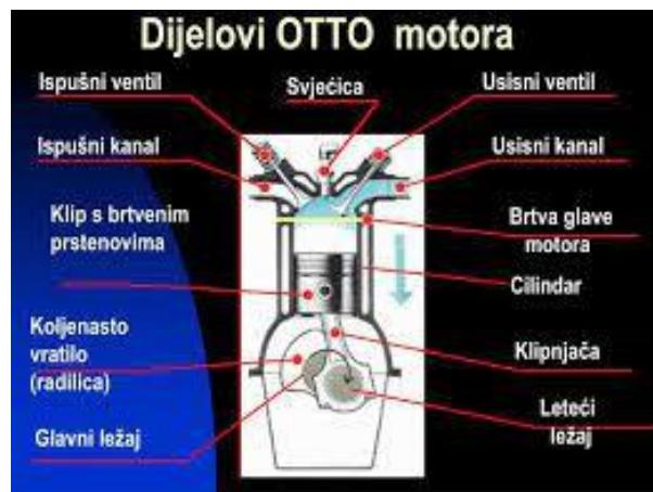
Slika 3. dijelovi Otto motora [9]
