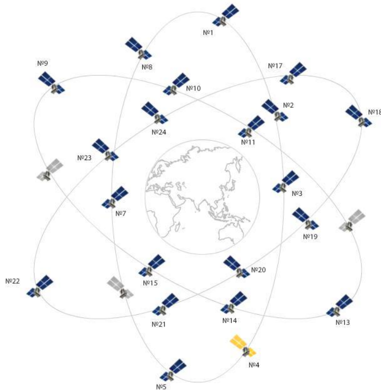
Slika 4. Položaj orbita GLONASS satelita
