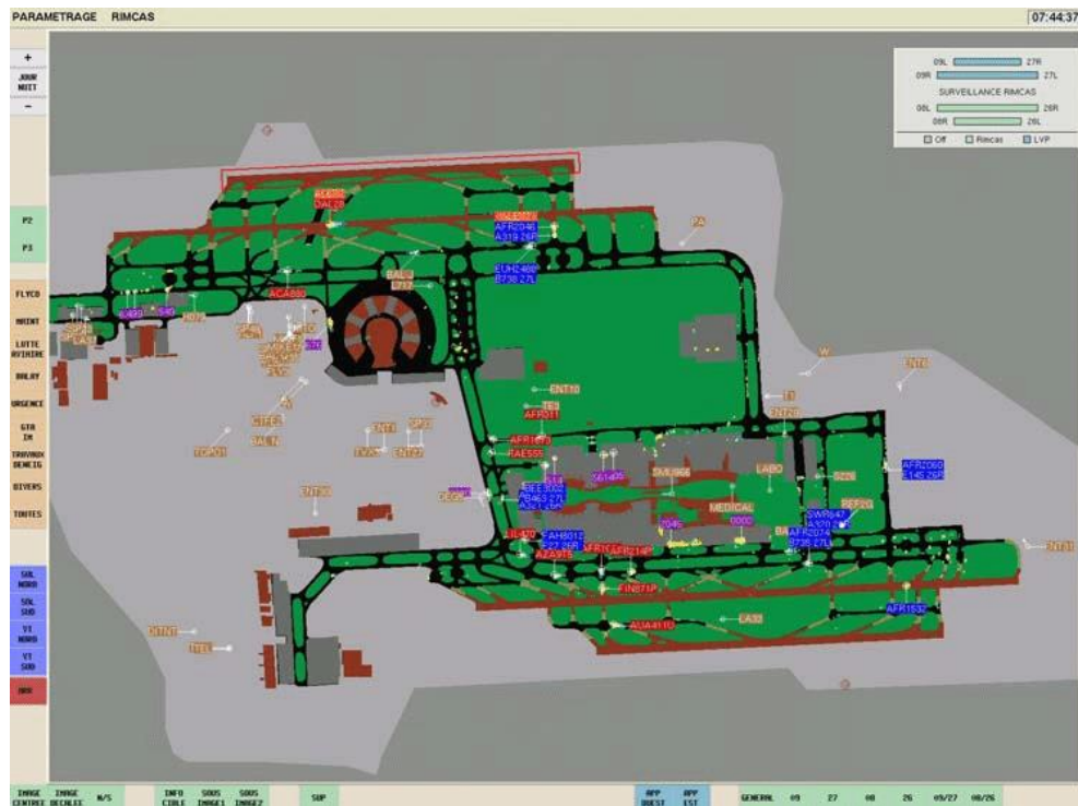
Slika 8. A-SMGCS sustav na monitorima kontrolora [13]
