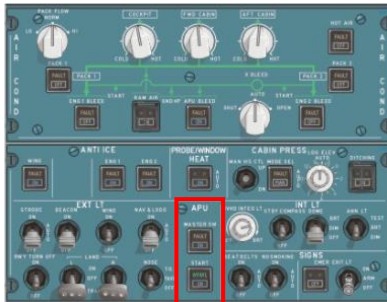
Slika 10. APU sekcija na panelu Airbusa A320, [10]
