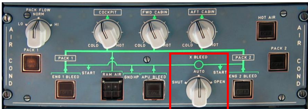
Slika 8. Križni ventil za stlačeni zrak na panelu klimatizacijskog sustava na Airbusu A320, [10]
