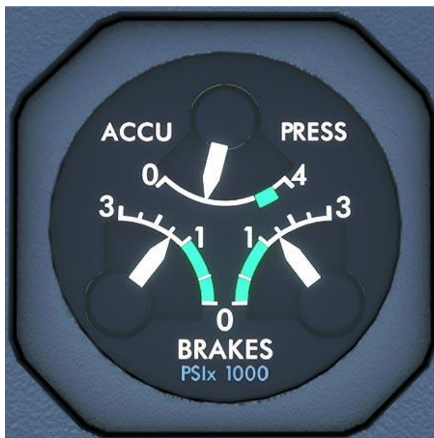
Slika 5. Indikator hidrauličkog akumulatora za alternativni kočioni sustav Airbusa A320, [7]
