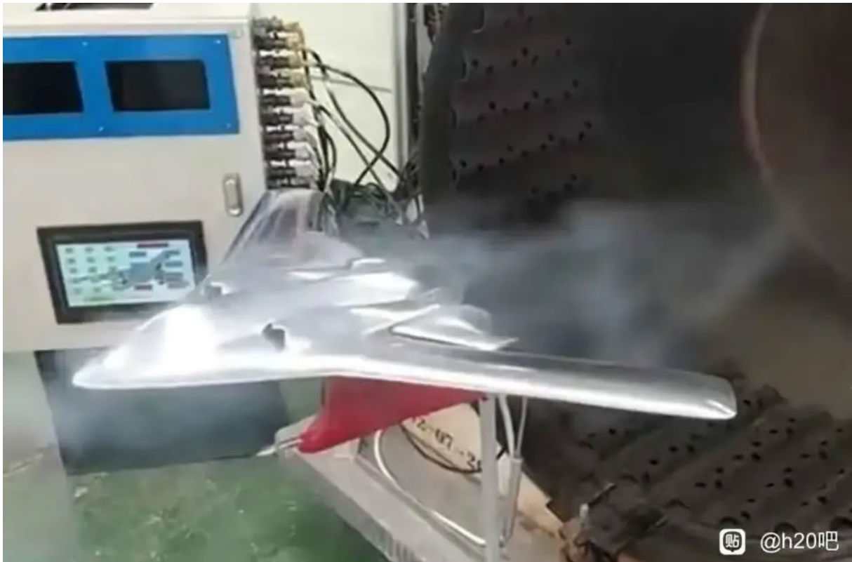
Slika 4 Model Xi'an H-20 u aerotunelu.
