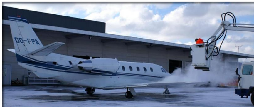
Slika 8. Postupak odleđivanja zrakoplova
