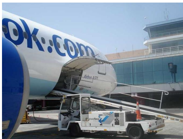
Slika 5. Istovar prtljage pomoću mobilne tekuće trake
