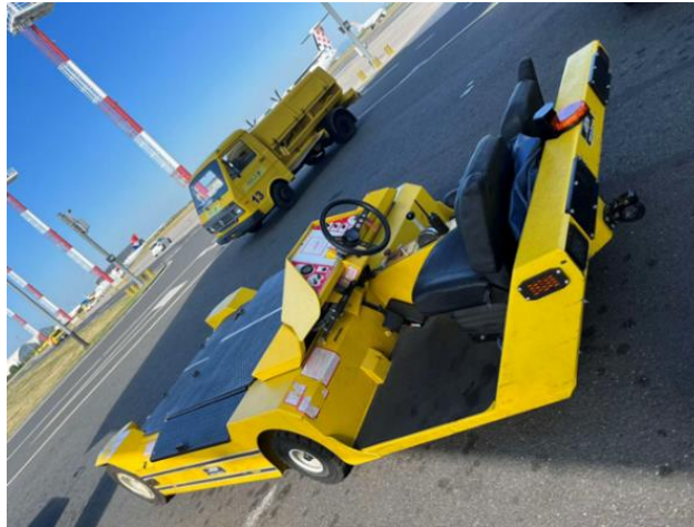
Slika 16. Push-back LEKTRO 88 na Zračnoj luci Franjo Tuđman
