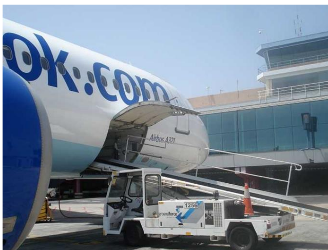
Slika 5. Istovar prtljage pomoću mobilne tekuće trake
