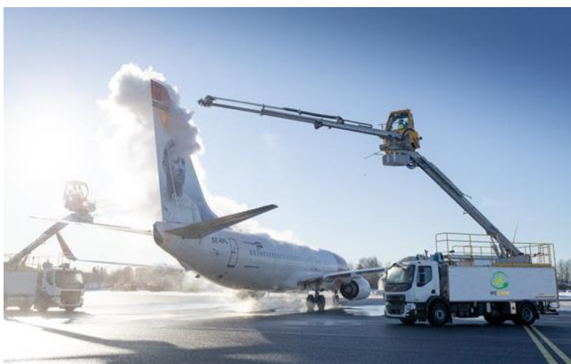
Slika 20. Električni odleđivač Elephant e-BETA u zračnoj luci Helsinki Izvor: [30]
