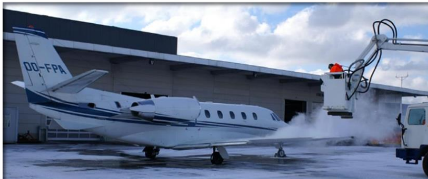
Slika 8. Postupak odleđivanja zrakoplova
