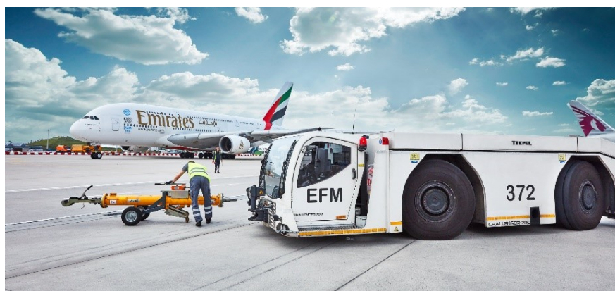
Slika 16. Traktor za izguravanje zrakoplova s pozicije
