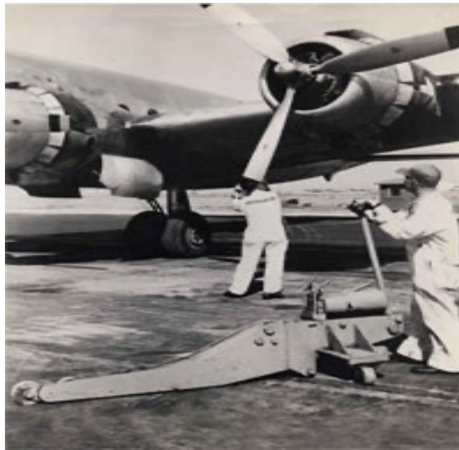
Slika 17. Dizalica za zrakoplove
