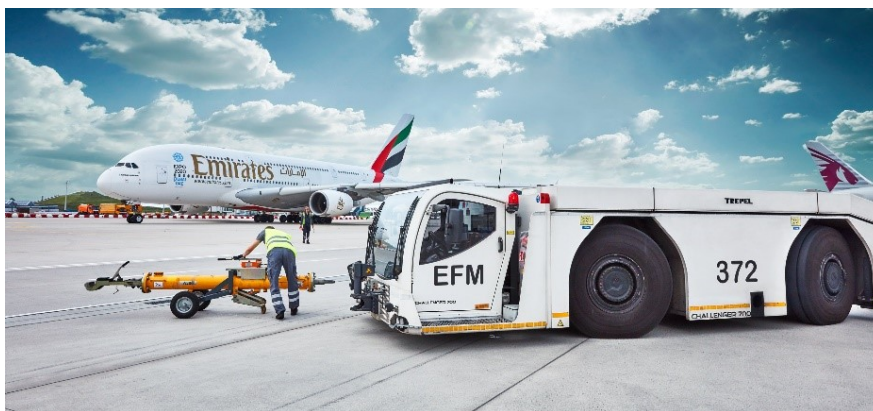
Slika 16. Traktor za izguravanje zrakoplova s pozicije
