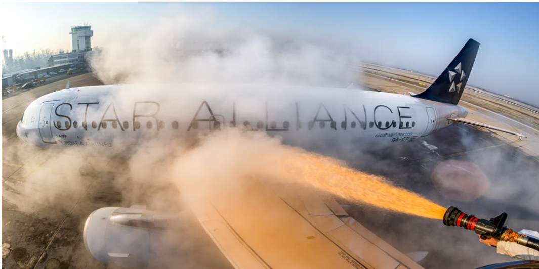
Slika 12. Prikaz odleđivanja zrakoplova
