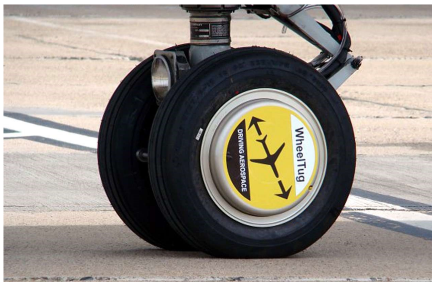
Slika 21. Prikaz WheelTug sustava
