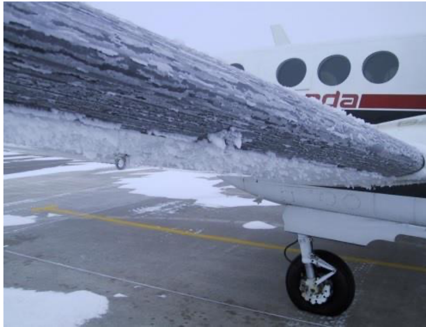
Slika 11. Prikaz kontaminata na aerodinamičkoj površini
