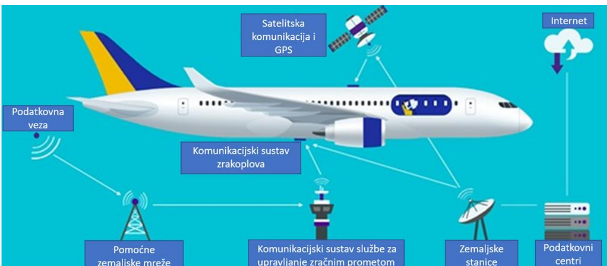
Slika 4. Komunikacija zemaljskih i zračnih stanica sa zrakoplovom
