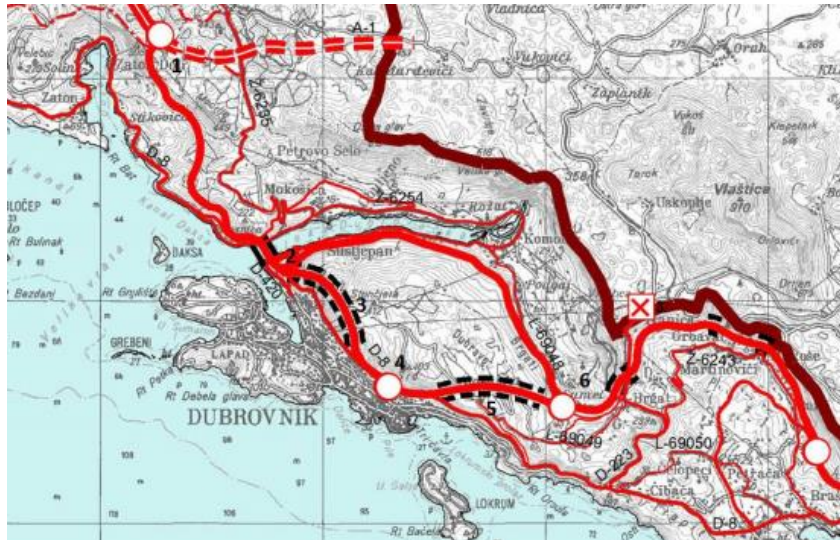
Slika 8. Varijanta 1 brze ceste Dubrovnik – Debeli brijeg, čvor Osojnik (1), čvor Dubrovnik–zapad (2), tunel Nuncijata (3), čvor Ilijina glavica (4), tunel Srđ (5), čvor Dubrovnik istok (6)
