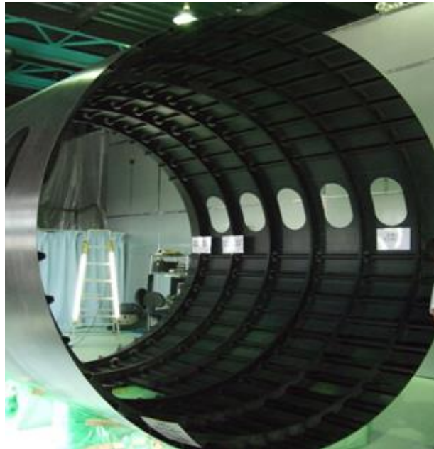
Slika 18. Trup zrakoplova izrađen kompozitnih materijala
