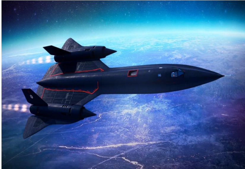
Slika 9. Prikaz nadzvučnog zrakoplova SR-71 Blackbird izrađenog uglavnom od titana
