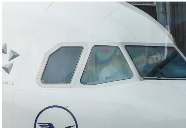
Slika 13. Prozori na zrakoplovu izrađeni od pleksi stakla
