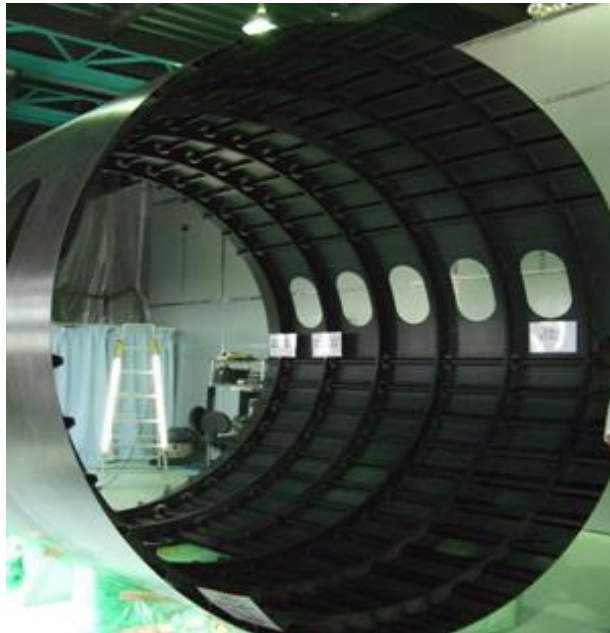
Slika 18. Trup zrakoplova izrađen kompozitnih materijala
