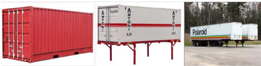
Slika 8 Osnovne intermodalne transportne jedinice
