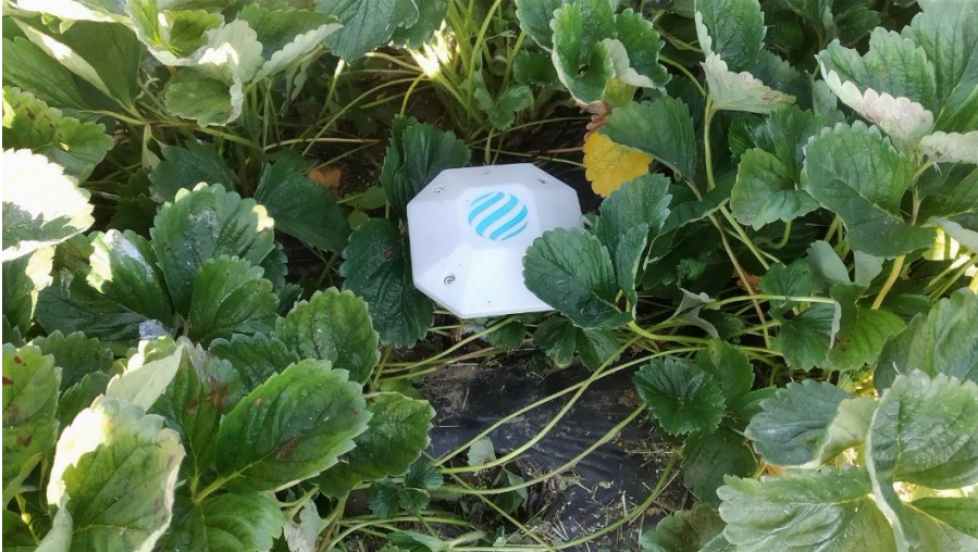
Slika 23. RSMT3L senzor vlage i temperature
