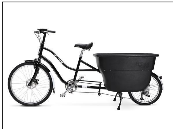
Slika 7. Teretni bicikl sa stražnjim utovarnim prostorom marke „Madsen“ Izvor: [7]
