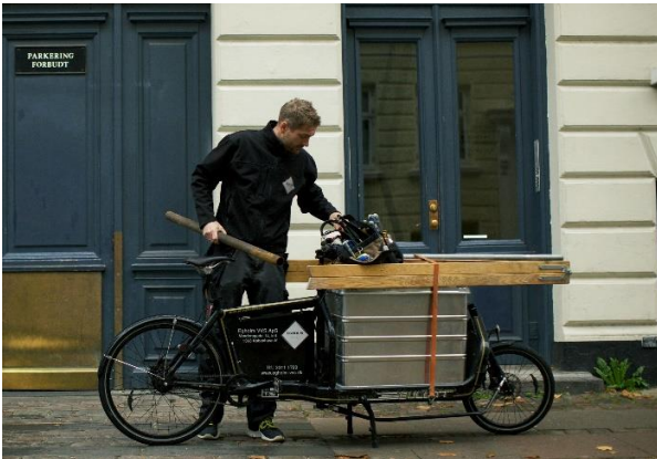
Slika 6. Teretni bicikl s prednjim utovarnim prostorom marke „Bulit“ Izvor: [6]
