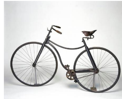
Slika 3. Rover izum Johna Kempa Starleya Izvor: [17]
