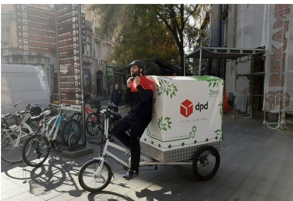
Slika 8. Teretni tricikl stražnjeg utovarnog prostora DPD kurirske tvrtke
