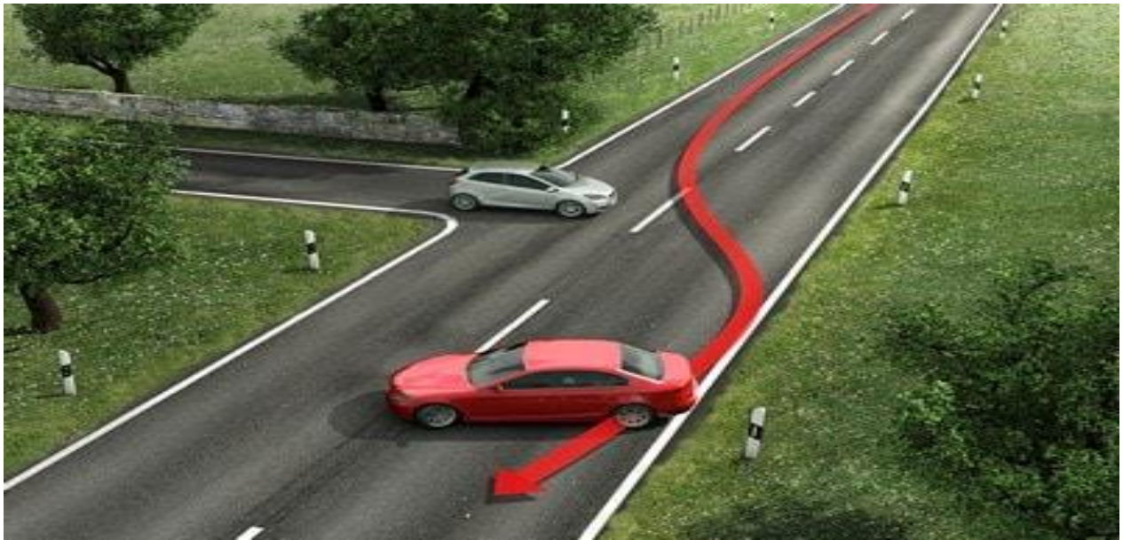
Slika 22. Izbjegavanje zapreke bez ESP-a [37]
