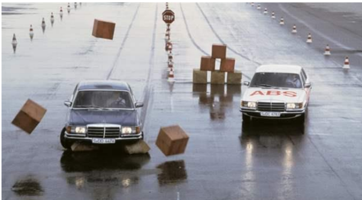
Slika 3. Primjer vozila s i bez ABS-a [34]
