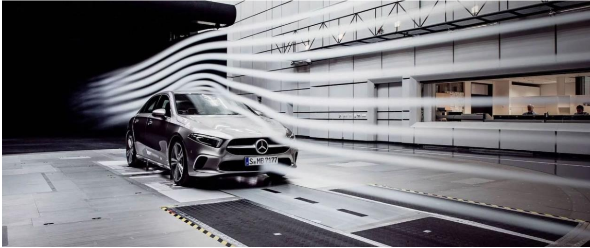
Slika 17. Ispitivanje aerodinamike vozila u zračnom tunelu [25]
