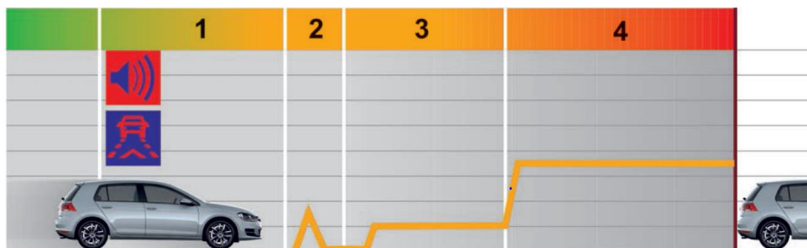
Slika 9. Sustav za kočenje u slučaju opasnosti marke Volkswagen Golf [20]
