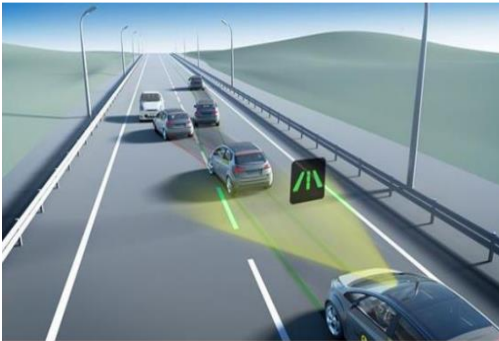
Slika 18. Prikaz aktiviranja LKA sustava
