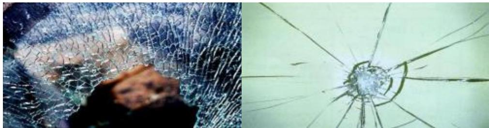
**Slika 15.** Kaljeno staklo (lijevo) i laminirano staklo (desno)
