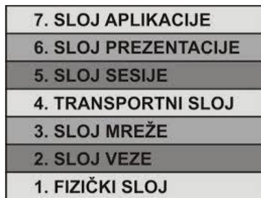
Slika 1. Prikaz slojeva OSI referentnog modela 3
