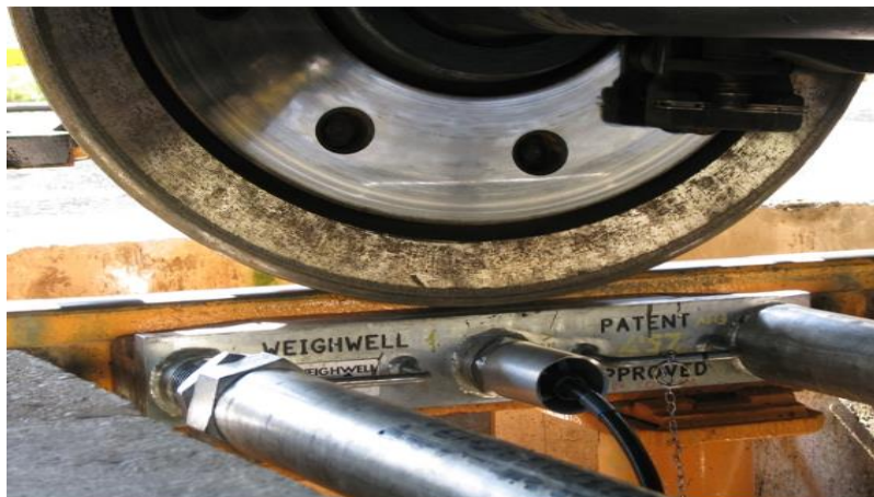
Slika 12. Mjerenje mase i osovinskih pritisaka
