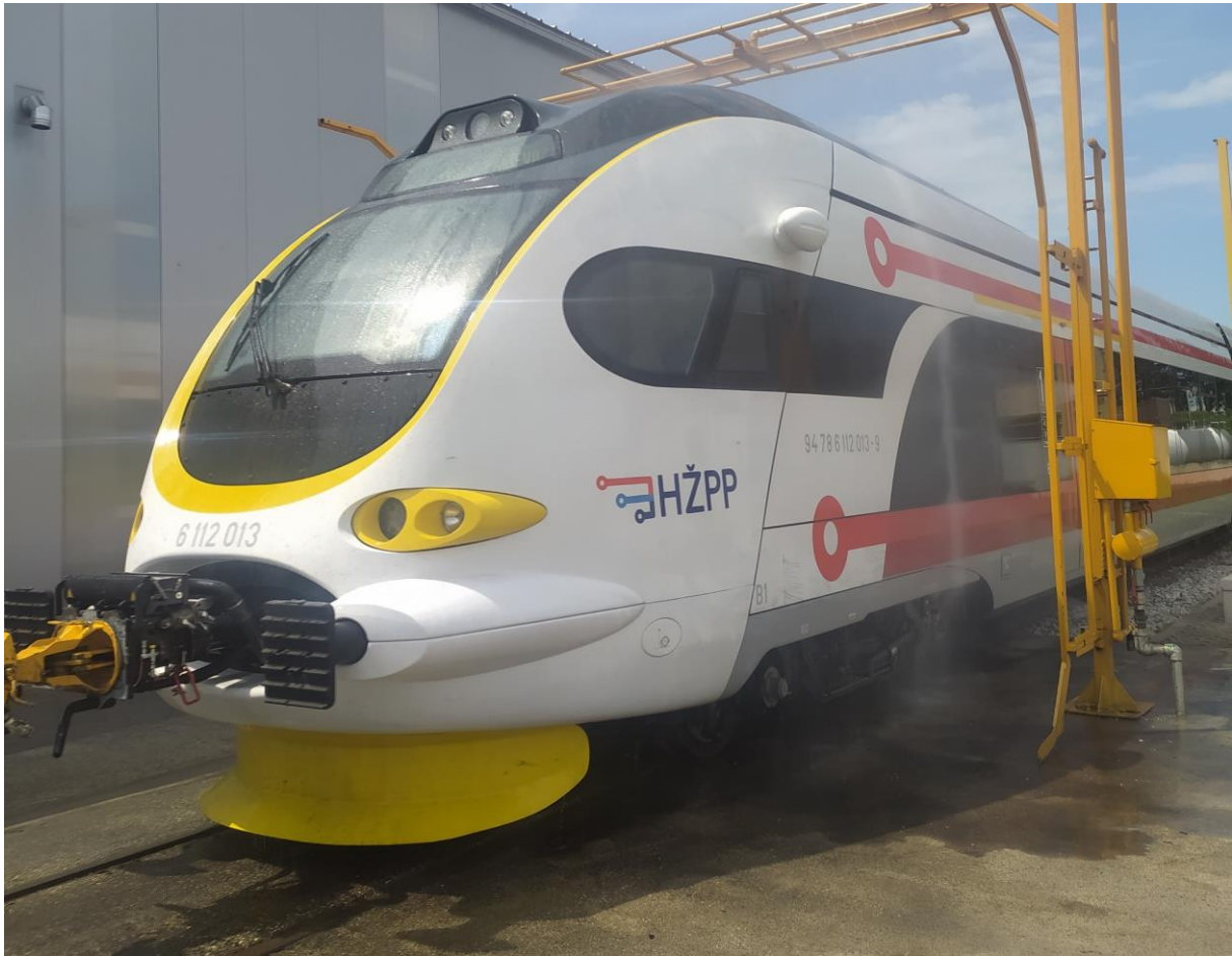
Slika 13. Ispitivanje vodonepropusnosti na umjetnoj kiši EMV-a 6112
