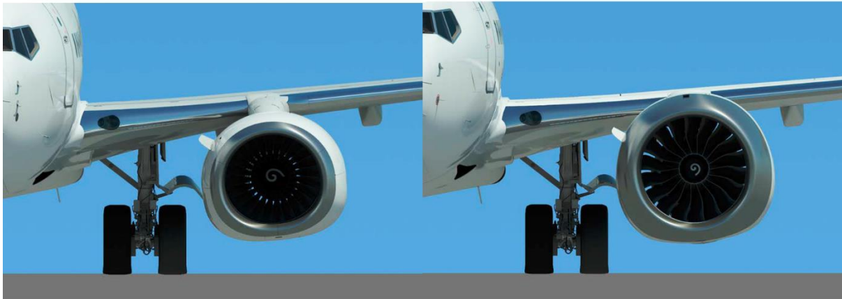
Slika 7. Razlika između motora Boeinga 737 NG (lijevo) i 737 MAX (desno), [30]
