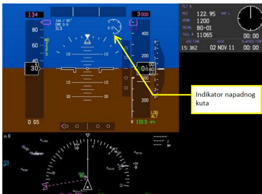
Slika 13. Napadni kut prikazan na primarnom zaslonu pilota Boeinga 737 MAX 8
