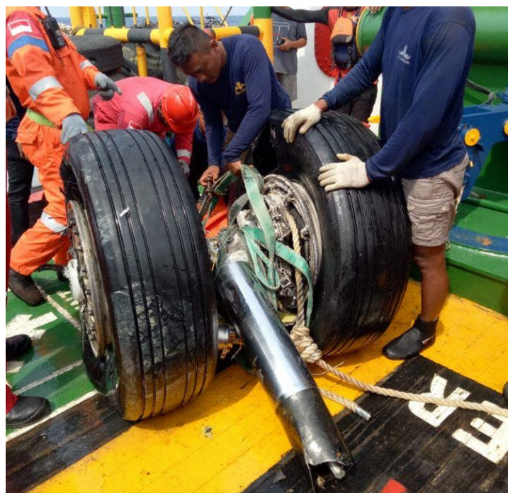
Slika 16. Izvučeni dio stajnog trapa zrakoplova PK-LQP, [46]
