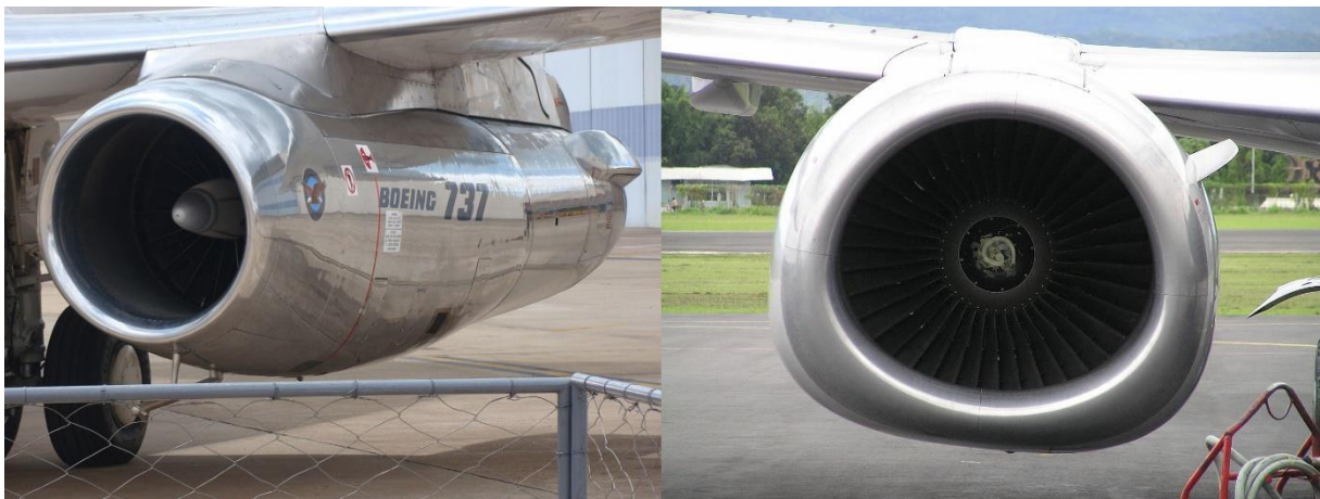
Slika 4. Razlika između gondole Boeinga 737-200 (lijevo) i 737-300 (desno), [11], [12]
