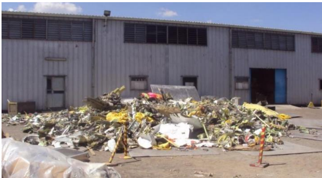
Slika 19. Prikupljeni dijelovi olupine zrakoplova ET-AVJ, [47]
