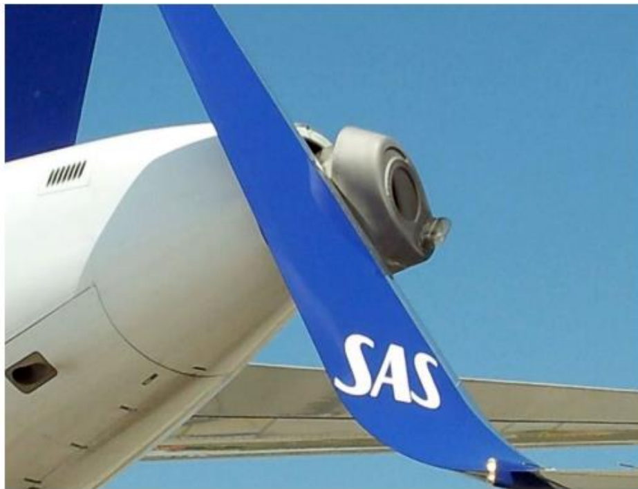
Slika 19. Fotografija kako je B737-800 zapeo na mlaznicu APU-a A320
