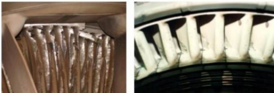
Slika 15. Primjer istrošenih lopatica turbine i kompresora [39]
