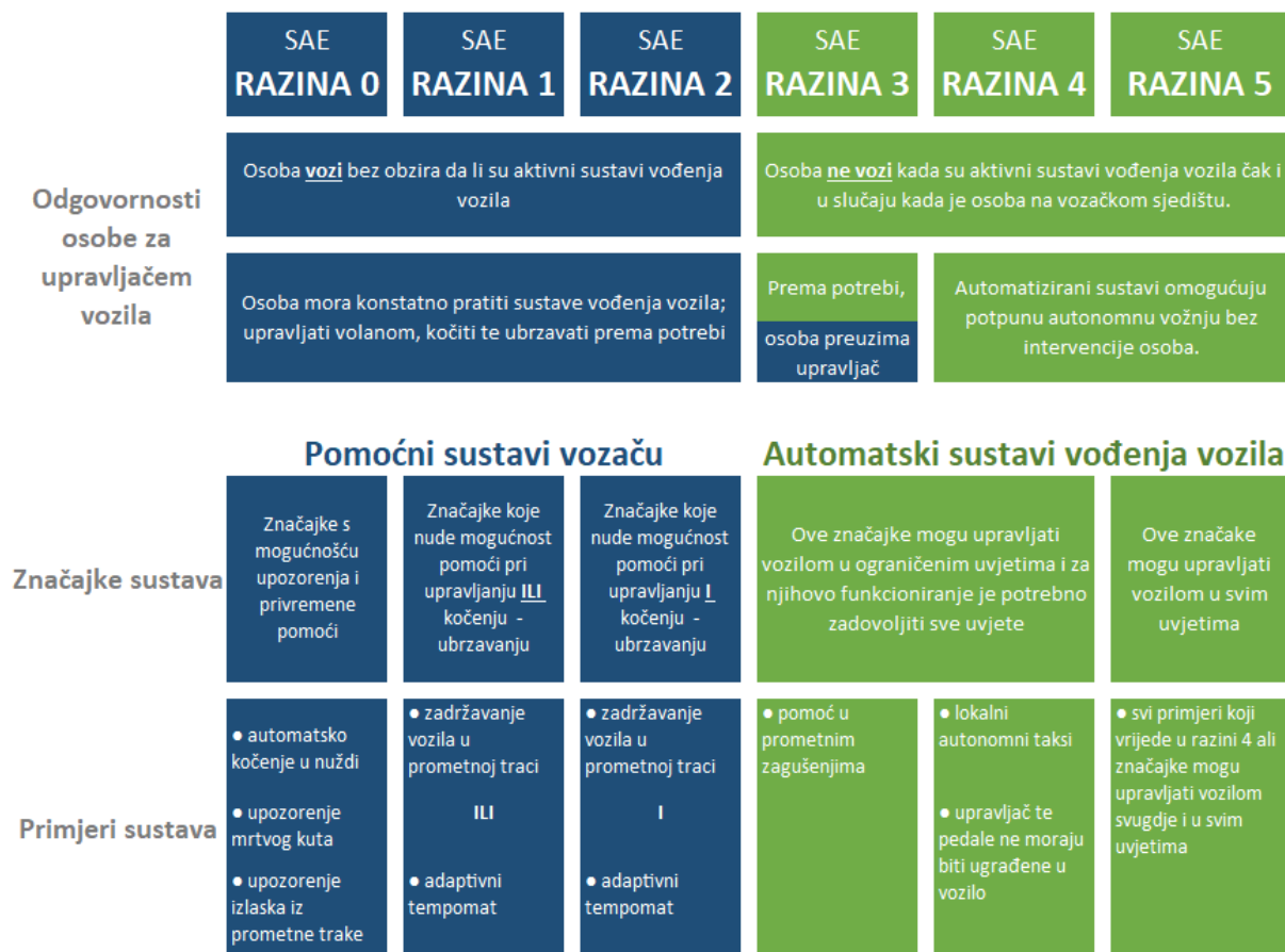
Slika 15. Prikaz SAE razina autonomnosti vozila prema značajkama ugrađenih sustava pomoći vozaču [izradio autor prema [23]]
