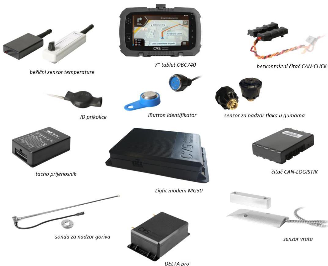
Slika 13. Prikaz dostupne CVS telematike [17]
