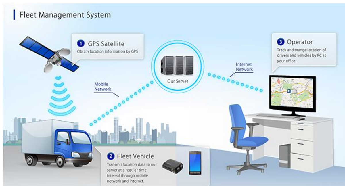
Slika 1. Osnovni prikaz toka informacija korištenjem sustava za upravljanje voznim parkom [2]
