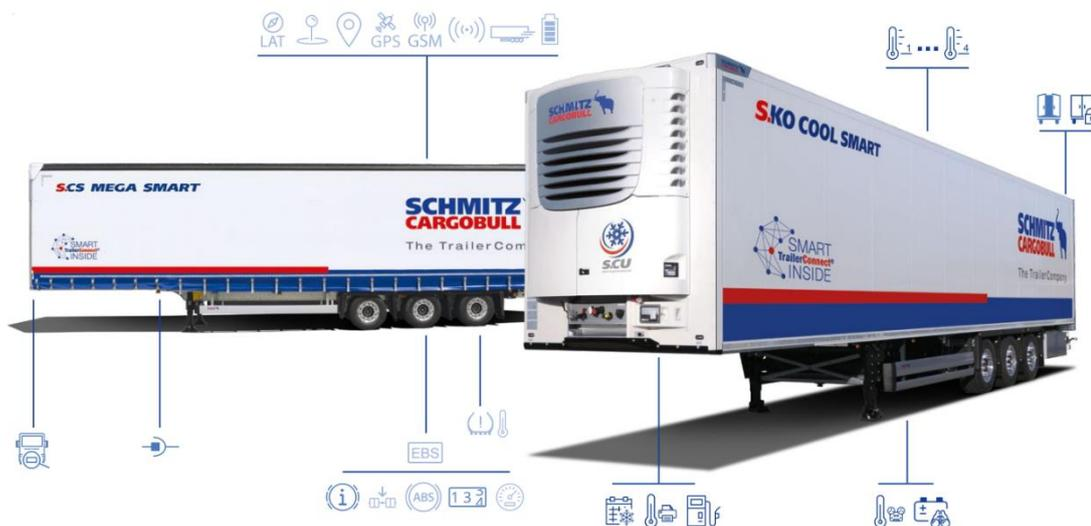
Slika 9. Prikaz praćene telematike poluprikolica proizvođača Schmitz Cargobull [16]
