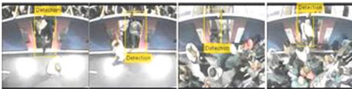
Slika 24. Detekcija putnika primjenom HOG metode [36]
